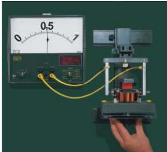
Arbeitsweise des elektrodynamischen Mikrofons
