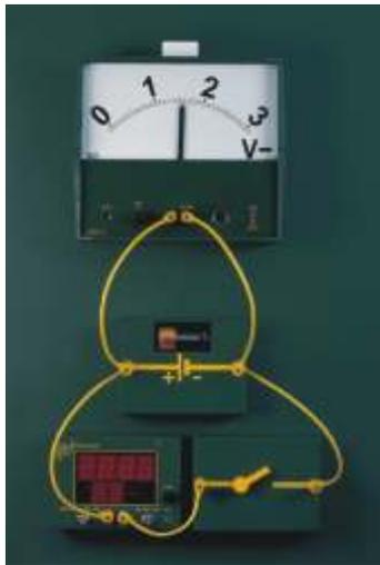
**12** Parallelschaltung von Spannungsquellen – Kurzschlussstrom
