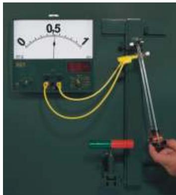
Wechselwirkung zwischen fester Spule und bewegtem Magnet und festem Magnet und bewegter Spule
