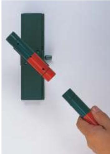
Wechselwirkung zwischen drehbar gelagertem Magnet und freiem Magnet
