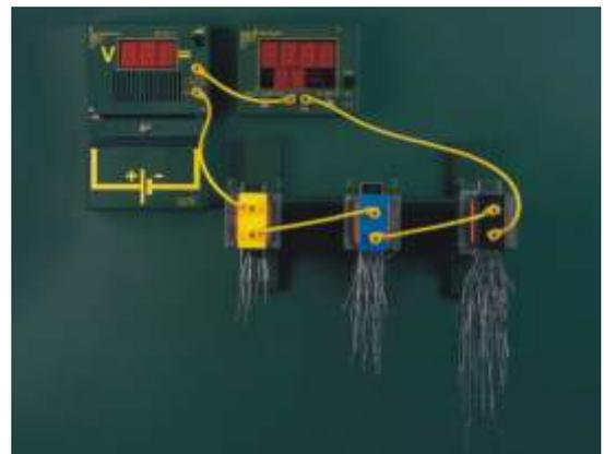
**83** Abhängigkeit der Magnetkraft einer stromdurchflossenen Spule von der Windungszahl
