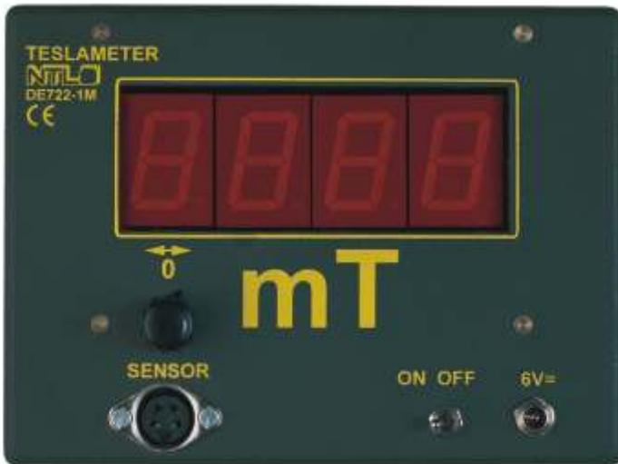
Dieses Gerät dient zur Messung magnetischer Kraftflussdichten bis zu einer Größe von  $\pm 200$  Millitesla.
