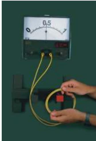
**128** Induktionsspannungen in Leiterschleifen
