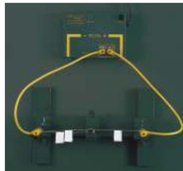
**49** Wärmeentwicklung bei verschiedenem Drahtquerschnitt
