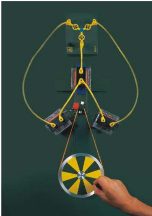
**01** Drehstromgenerator – Erzeugung von Drehstrom
