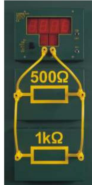
Messung mit dem Ohmmeter
