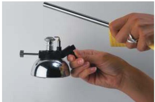
Entmagnetisierung durch Erwärmung
