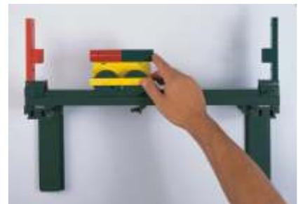
Wechselwirkung zwischen zwei drehbar gelagerten Magneten
