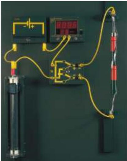
**76** Kraftwirkung eines flexiblen stromdurchflossenen Leiters im inhomogenen Magnetfeld eines Stabmagneten
