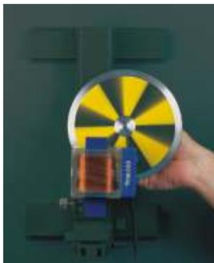
Erzeugung eines Drehfeldes – Spaltpoleffekt
