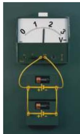
Parallelschaltung von Spannungsquellen
