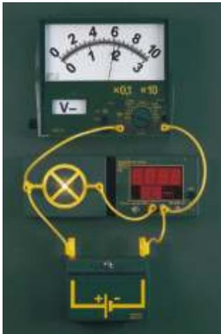
**44** Innenwiderstand von Spannungsquellen
