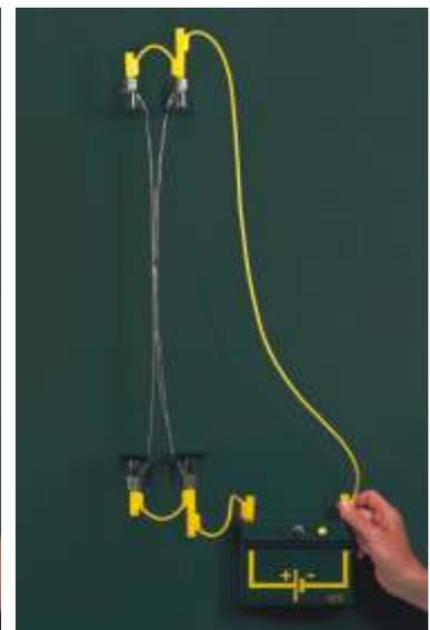
Kraftwirkung zwischen parallelen stromdurchflossenen Leitern
