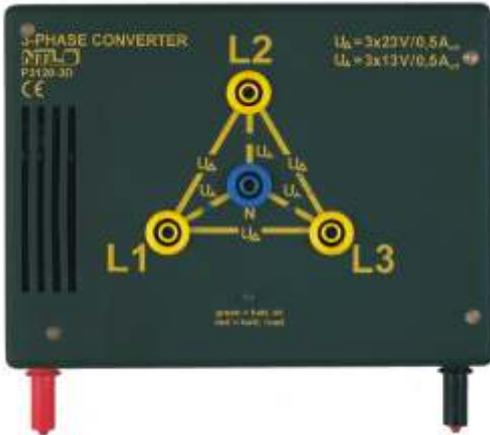
Hauptanwendung dieses Gerätes ist die Durchführung von Experimenten mit Drehstrom. Dieses Gerät ermöglicht in Verbindung mit der Box-Akku 6 V/10 Ah, magnethaftend P3120-1B oder Box-Festspannungstrafo, magnethaftend P3120-1N alle wesentlichen Drehstromversuche zur Schulphysik auch wenn im Experimentiersaal kein Drehstromanschluss vorhanden ist.
