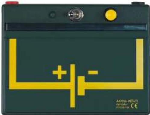
Die Box-Akku 6V/10 Ah liefert eine feste Gleichspannung von 6 V bei einem Kurzschlussstrom  $> 30$  A. Die Box-Akku 6V/10 Ah wurde speziell für den Einsatz mit den abgebildeten Konvertern sowie für Hochstromversuche entwickelt.
