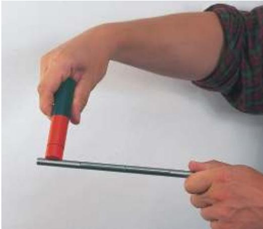
Entmagnetisierung durch Erschütterung
