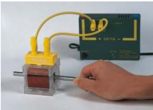
Entmagnetisierung durch ein magnetisches Wechselfeld
