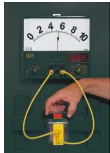
Abhängigkeit der Induktionsspannung von der Bewegungsgeschwindigkeit
