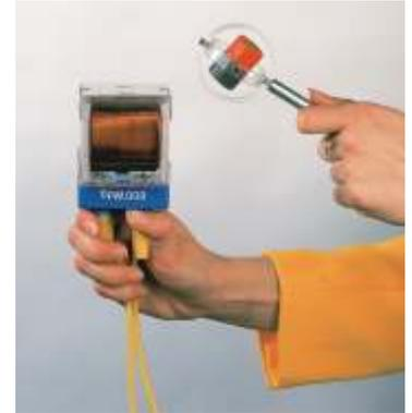
Polbestimmung einer stromdurchflossenen Spule
