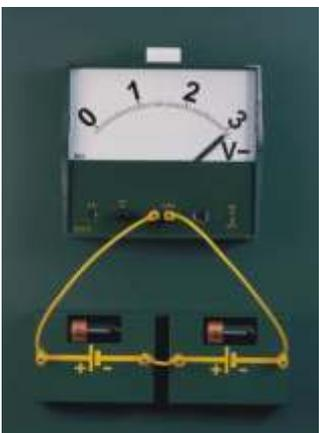
Reihenschaltung von Spannungsquellen
