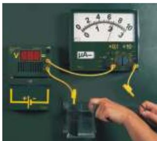
**19** Schließung des Stromkreises mittels Erdleitung
