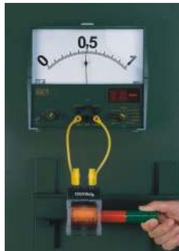
**129** Entstehung der Induktionsspannung in einer Spule
