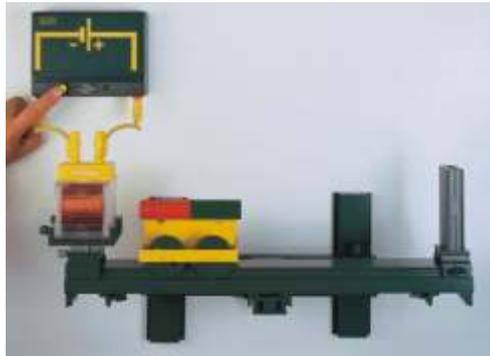
**80** Magnetische Kraftwirkung einer stromdurchflossenen Spule
