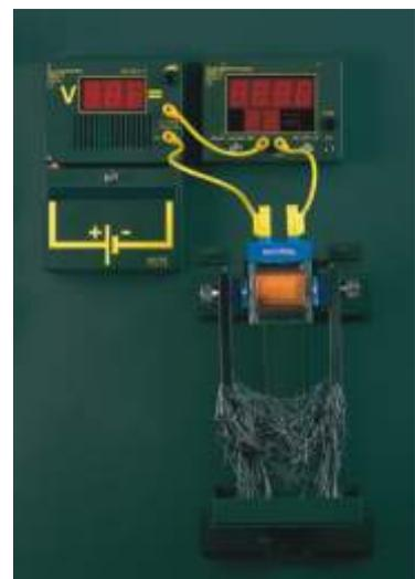
**79** Magnetkraft einer stromdurchflossenen Spule
