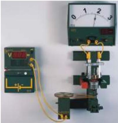
**166** Gleichstromgenerator mit Trommelanker
