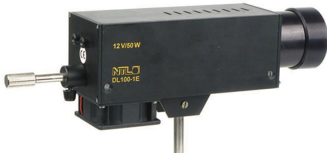
Universelle, extrem helle Lichtquelle für optische Experimente; Lampeneinsatz G6,35 mit Xenonglühlampe 12 V/50 W (im Lieferumfang enthalten!); drehbarer und verschiebbarer Stelltrieb zur seitlichen und axialen Lampenjustierung; Kondensorlinse, Fl: +100 mm, in Alu-Rohr, justierbar und abnehmbar; Metallgehäuse mit Gelenkstiel (L= 60 mm), zum Neigen der Leuchte; Kühlung durch angebaute Ventilator; Anschlussspannung: 12 V über zwei 4-mm-Buchsen; Abmessungen: 300 x 60 x 85 mm
