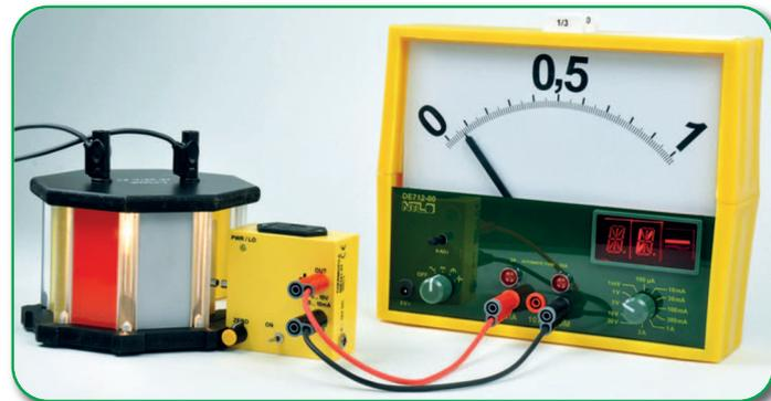
**Versuch:** Wärme-Oktogon + Thermpile + Demo-Multimeter
