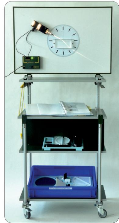
Versuch: Einfallis- und Brechungswinkel im Wasser
