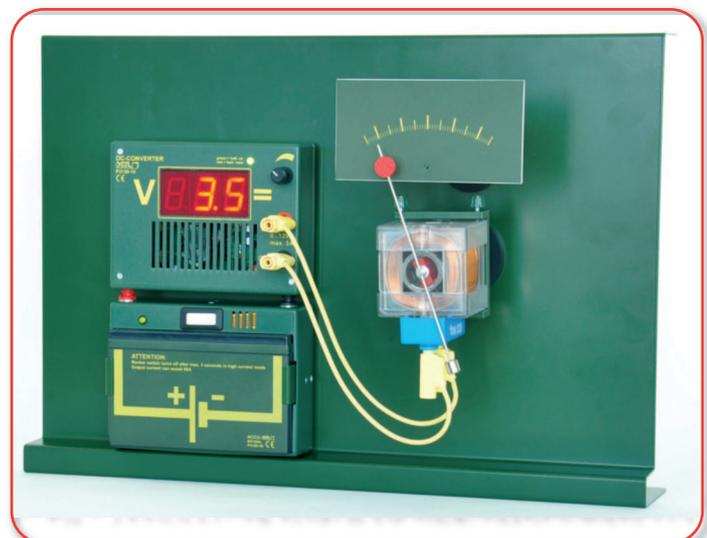
**Versuch:** Modell eines Dreheisenmesswerkes
