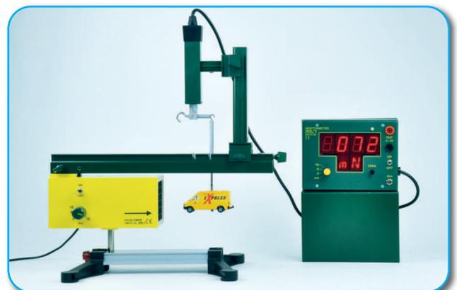
**Versuch:** Messung des Luftwiderstandes an verschiedenen Automodellen
