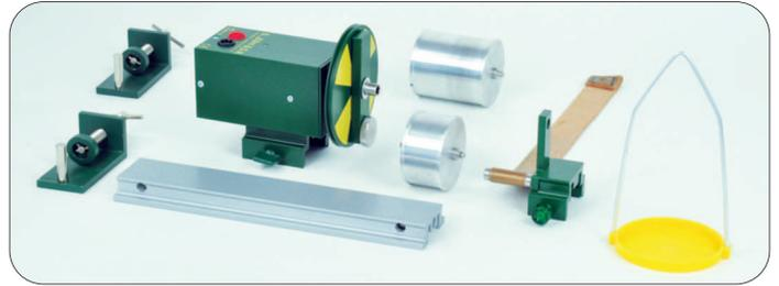
Zur Demonstration des mechanischen Wärmeäquivalentes;
