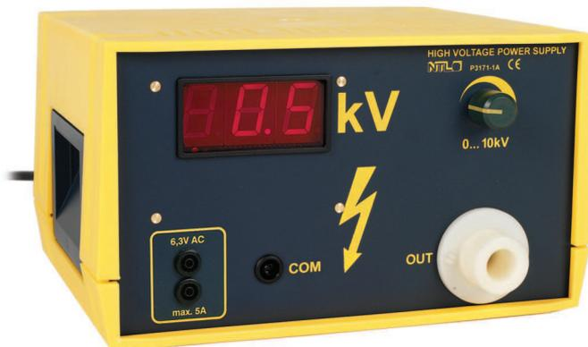
Stufenlos stellbare Hochspannungsquelle zur Versorgung von Elektronenbeugungsröhren.
