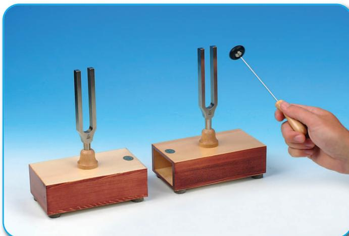
**Versuch:** Schallübertragung in Luft
