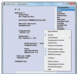
Im ersten Beispiel wird eine Steuerung für eine Schaufensterbeleuchtung erstellt.
