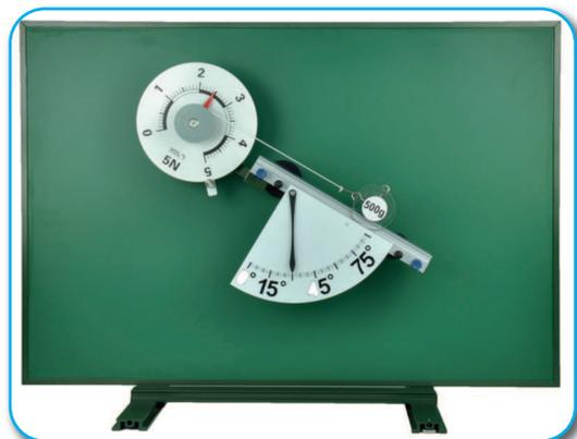
**Versuch:** Geneigte Ebene (Magnetaufbau)
