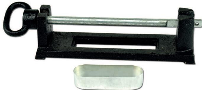
Zur Demonstration der bei Temperaturänderung in festen Stoffen auftretenden Kräfte; Plattform mit Einspann-Gabel aus Gusseisen, Stahlstab mit großer Spannmutter mit Griffing sowie mit Loch zum Einspannen der Bolzen, Behälter für Brennmaterial (Lieferung ohne Bolzen und Brennmaterial),
