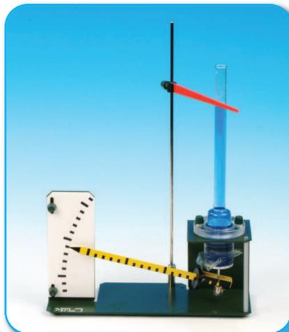
**Versuch:** Hydrostatisches Paradoxon
