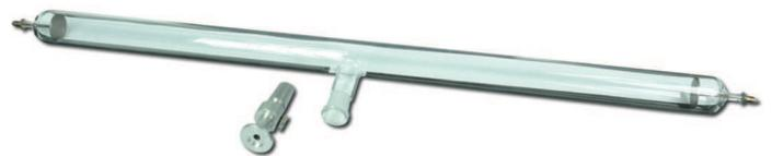
Zur Demonstration der druckabhängigen Leuchterscheinungen bei einer Gasentladung; Dickwandiges Glasrohr mit mittigem Absaugrohr mit NS19/26, an den Enden Scheibenelektroden mit außenliegenden Metallkappen zur Zuführung von Hochspannung; Kupplungsstück aus Metall mit DN 16 Flansch und Belüftungsschraube; L=ca. 700 mm, D=50 mm
