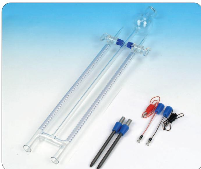
Zur Elektrolyse von Wasser;
