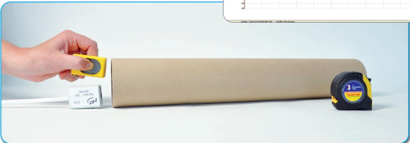
**Versuch:** Messung der Schallgeschwindigkeit
