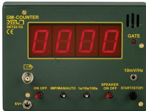
Demonstrations-Messinstrument zur quantitativen Erfassung ionisierender Strahlung; das Gerät ist sehr handlich und magnethaftend; die 26-mm-große LED-Anzeige erlaubt eine exakte Ablesung auch aus größerer Entfernung
