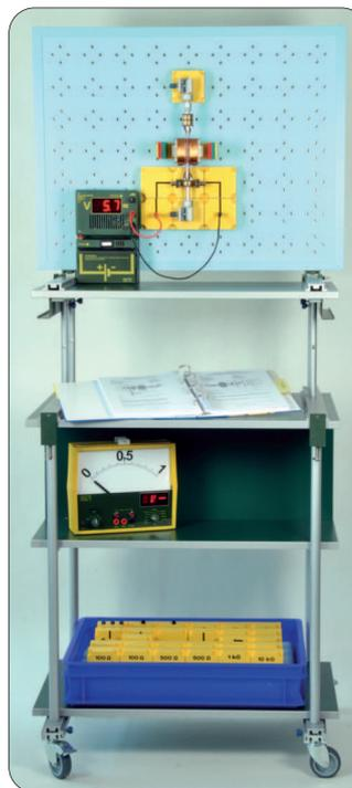
Versuch: Elektromotor mit Zweipolrotor
