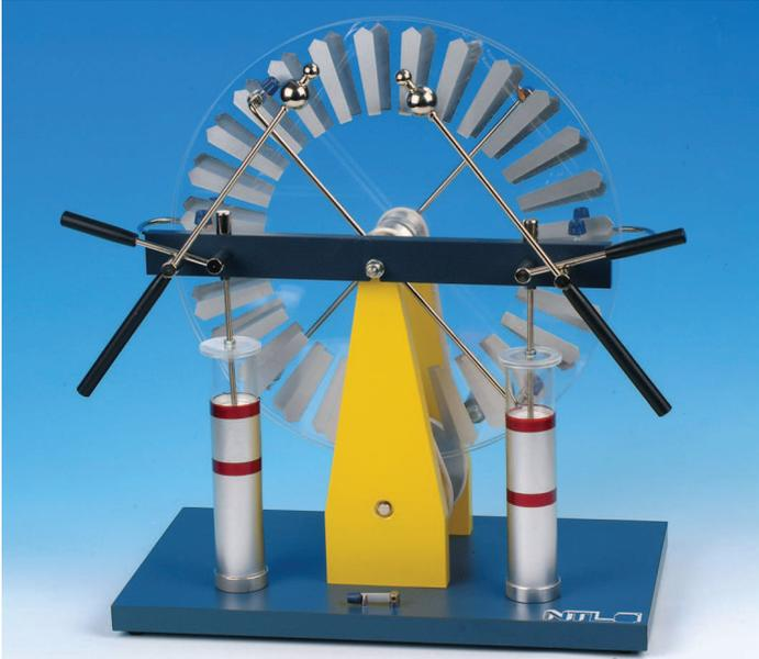
Maschine nach Wimshurst, zur Erzeugung sehr hoher Gleichspannungen;
