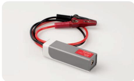
Zur Messung von Strömen in Gleich- und Wechselströmen im Bereich von  $-12,5$  mA bis  $+12,5$  mA.
