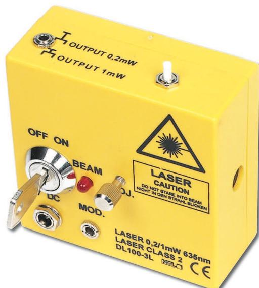
Unterrichtslaser der Klasse 2 zur Verwendung als Lichtquelle hoher Intensität speziell für Versuche zur Interferenz, Beugung und Holographie;
