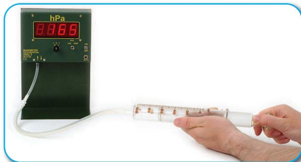
**Versuch:** Messung von Überdruck und Unterdruck
