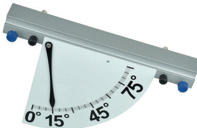
Zur Demonstration der Versuche zur „Geneigten Ebene“; NTL-Schienenprofil, silber beschichtet; zwei Stativstangen zur Befestigung; mit großer Metall-Skala 0 – 90°; Schraube zur Befestigung des Torsionskraftmesserhalters; Schienenlänge: 320 mm; Zeigerlänge der Skala: 130 mm; Ziffernhöhe der Skala: 26 mm
