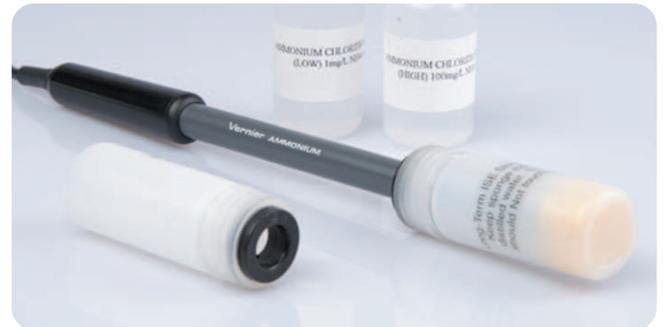
Dieser Sensor dient zur Bestimmung der Ammoniumkonzentration in wässrigen Lösungen.
