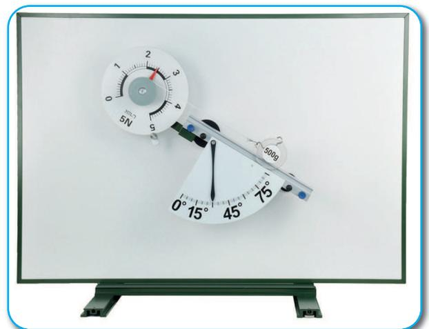
**Versuch:** Geneigte Ebene (Magnetaufbau)
