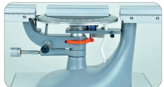
Ein eingebautes zahnradbetriebenes Potentiometer ermöglicht die Auswertung der Winkelposition am Computer mit entsprechender Software (z.B. Coach 6)
