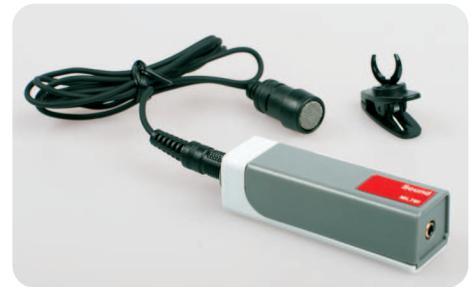
Der Sensor misst die bei einer Schallwelle auftretende Änderung des Luftdrucks. Aufgrund der hohen Sensitivität des Sensors ist dieser sehr gut für die Messung kurzer Druckstöße geeignet, was ebenfalls die Möglichkeit einer Schallgeschwindigkeitsmessung zulässt.
