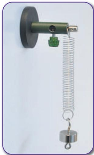
**DS110-43** Magnetfuß 43, mit Säule und Lagerbolzen
