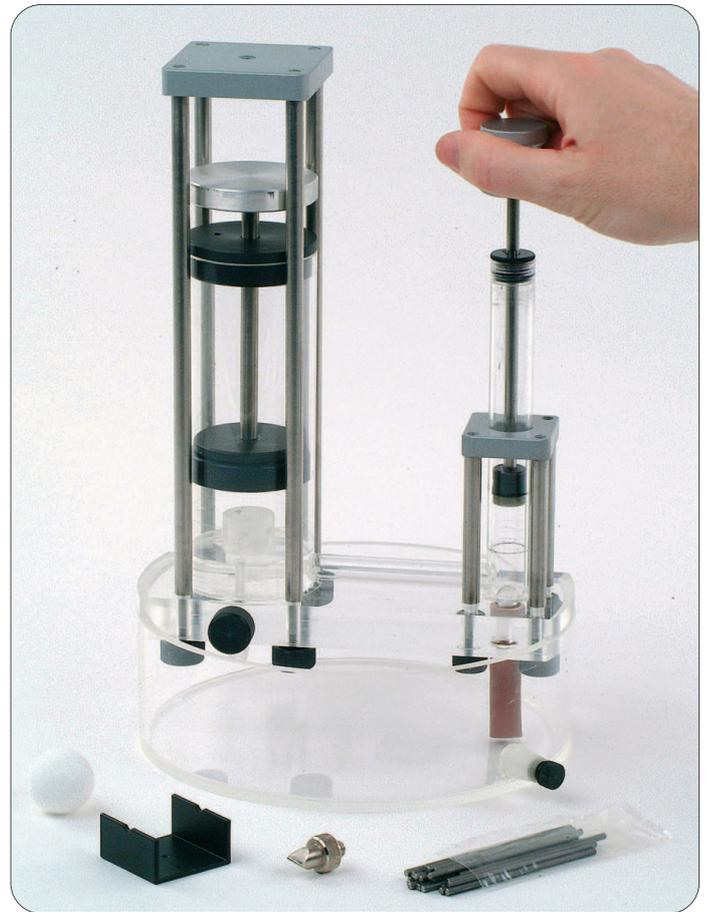
Acrylglasmodell zur Demonstration der hydraulischen Kraftübertragung;
