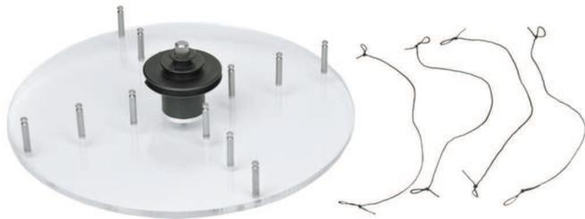
Für Versuche zu den Themen Drehbewegung und Trägheitsmoment; axial kugelgelagerte Acrylglascheibe,  $D = 160$  mm, mit Wellrad, zum Aufsetzen auf den Kräfte-Tisch, jeweils 3 zu  $90^\circ$  angeordnete Metallbolzen im Abstand von 25/50/75 mm zum Zentrum, zur Aufnahme von Schnüren oder Schlitzgewichten; Wellrad:  $D = 8/16/32$  mm
