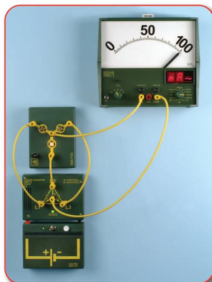
**Versuch:** Sternschaltung – Stromstärke im Mittelpunktsleiter (Magnettafelauflbau)
