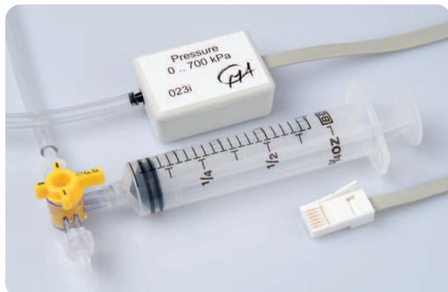
Der Drucksensor ist in der Lage den Gasdruck im Bereich von 0 bis 700 kPa (0 bis 7 atm) zu messen.
