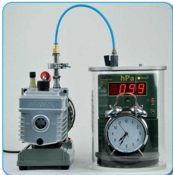
**Versuch:** Schallübertragung im luftleeren Raum
