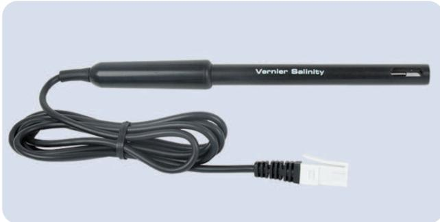
Dieser Sensor dient zur Bestimmung des Salzgehaltes in Flüssigkeiten. Der Sensor besteht aus einer Elektrode und einem Verstärker und verfügt über eine automatische Temperaturkompensation.
