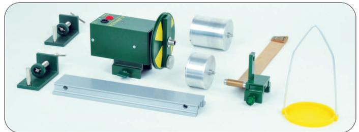
Zur Demonstration des mechanischen Wärmeäquivalentes; starker Antriebsmotor mit Getriebe, Antriebswelle mit Adapter zur Aufnahme der Sechskant-Achse einer Alu-Vollwalze; zwei Vollwalzen aus Aluminium mit erhöhtem Rand zur Auflage und Führung eines Lederbandes, welches im Betrieb eine gleichmäßige Reibung herbeiführt; Walzen jeweils mit Lager- und Antriebsachse;
