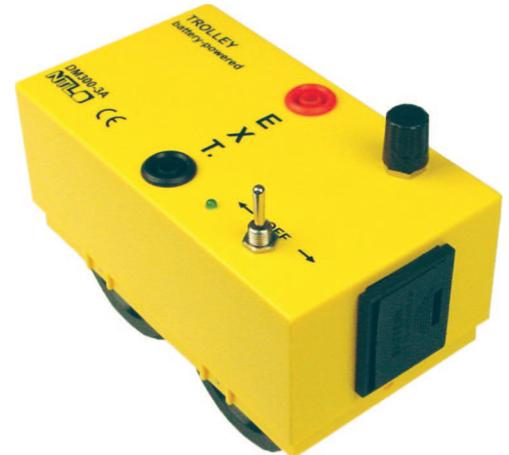
Batteriebetrieben; für Experimente zur gleichförmigen Bewegung; Potentiometer zur stufenlosen Verstellbarkeit der Geschwindigkeit; Wahlschalter: Vor/Aus/Zurück; Buchsen für externen Spannungsversorgung (ungleichförmige Bewegung); Batterie (9V) ohne Öffnen des Gehäuses wechselbar; Abmessungen: ca. 124x69x85 mm
