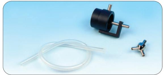
Zur Aufnahme des Staudruckes, des statischen- und Gesamtdruckes in Gasströmungen; Kunststoffzylinder mit 2 Metallrohren; aufsetzbar auf Rohraufsatz für Gebläse DM701-2K; ein Y-Verbinder zur Zusammenführung der Schläuche; Silikon Schlauch (L=100 cm) 3/6 mm
