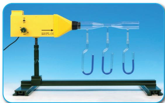
**Versuch:** Druck in einer Strömung – Venturirohr
