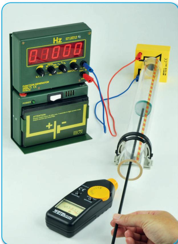
**Versuch:** Bestimmung der Wellenlänge bei unterschiedlichen Frequenzen (genaue Ermittlung der Maxima mit einem einfachen Schallpegelmessgerät analog)
