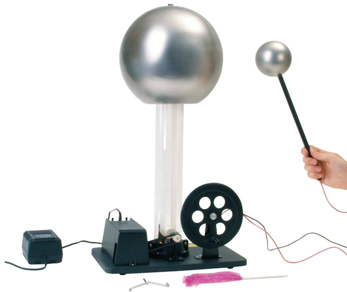
Zur Erzeugung sehr hoher Gleichspannungen für elektrostatische Versuche
