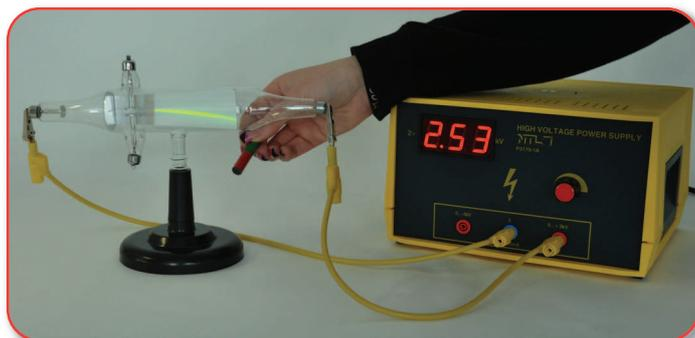
**Versuch:** Elektronenstrahlablenkung durch einen Magneten
