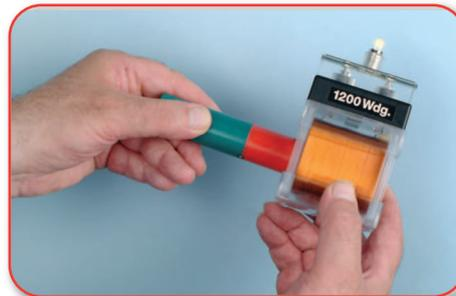
Versuch: Entstehung der Induktionsspannung in einer Spule
