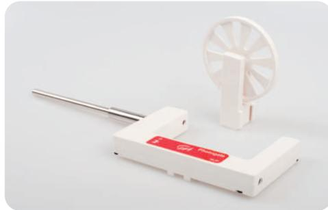
Die Gabellichtschranke wird mit einem aufsteckbaren Speichenrad mit Schnurrille und einer Stativstange geliefert. Sie kann entweder direkt über ein Interface verbunden, oder mit zusätzlichen Kabeln, an bis zu 5 weiteren Gabellichtschranken gekoppelt werden.
