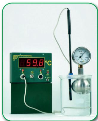
**Versuch:** Abschätzung des absoluten Nullpunktes
