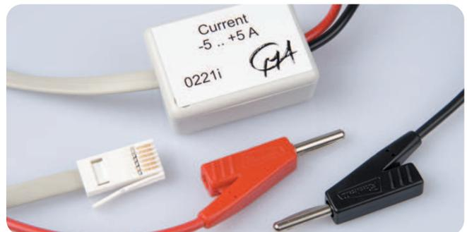
Dieser Sensor dient zur Bestimmung der Stromstärke im Bereich von  $-5$  und  $+5$  A.
