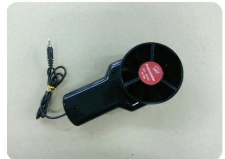
Mit dem Windsensor können Windgeschwindigkeiten im Bereich von 0,4 bis 35 m/s gemessen werden.
