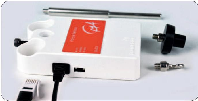
Ein vielseitig anwendbares Gerät um Kräfte zu messen. Es kann sowohl an einer Stativstange als auch auf beweglichen Körpern befestigt werden, um entweder Zug- oder Druckkräfte zu messen. Die Umschaltmöglichkeit zwischen den beiden Messbereichen ermöglicht Kräfte im Bereich von 0,01 bis 50 N zu erfassen.
