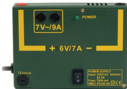
Die beiden Ausgangsspannungen sind über 4-mm-Sicherheitsbuchsen entnehmbar, kurzschlussfest und überlastgeschützt! Bei Überlast schaltet das Netzgerät ab.
