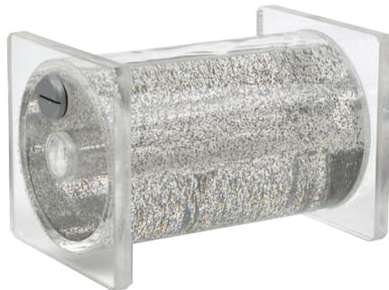
Zur räumlichen Darstellung des Magnetfeldes eines Stabmagneten; Acrylglaskörper gefüllt mit Spezialflüssigkeit und Eisenspänen; zentrale Bohrung zur Einführung eines Rundstabmagneten bis max. D=15 mm; Abmessungen: 126x102x102 mm
