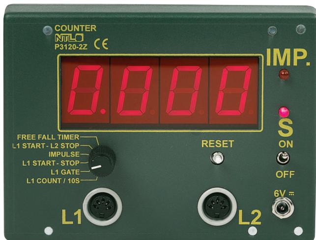
Universell einsetzbarer magnethaftender digitaler Zeitähler; batteriebetrieben; zum direkten Anschluss der Gabellichtschranken P1320-3LR oder Kugelfallgerät DM340-1F; 26 mm hohe LED-Anzeige; Auflösung: 1 ms
