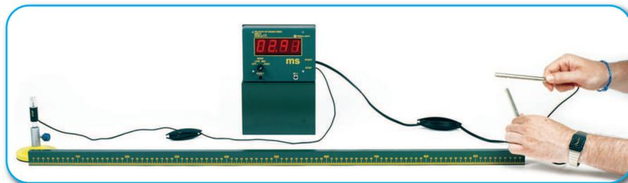
**Versuch:** Messung der Schallgeschwindigkeit in Luft
