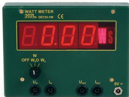
Demonstrations-Messinstrument zur Durchführung von Leistungsmessungen in Niederspannungskreisen. Das Gerät ist sehr handlich und magnetaftend; die 26-mm-hohe LED-Anzeige für den Messwert und die 20-mm-hohe LED-Anzeige für die Maßeinheit erlauben eine exakte Ablesung auch aus größerer Entfernung
