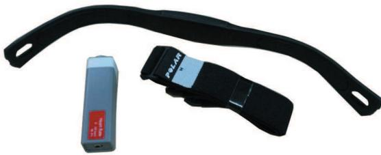
Das Sensorsystem besteht aus einem Signalempfänger und einem Messgürtel, der mittels eines elastischen Bandes am Körper fixiert werden kann.
