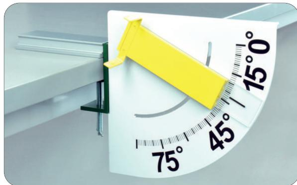
Zur Demonstration des Schiefen Wurfes mit festen Körpern oder Flüssigkeiten; Große Skala aus Metall mit rasch ver- und feststellbarem, breiten Zeiger in Signalfarbe, daher auch aus weiter Entfernung gut sichtbar; fix montierte Tischklemme sowie Fußwangenprofil zur Befestigung an Tischen bis zu einer Stärke von 48 mm; Metallbügel zur Auflage einer Wurfkugel; Ziffernhöhe der Skala: 26 mm; Abmessungen: 260x210x35 mm
