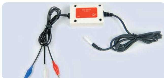
Der EKG-Sensor (Elektrokardiogramm) misst Spannung die vom menschlichen Herzen erzeugt wird.
