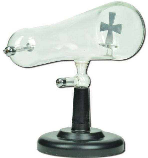
Zum Nachweis der geradlinigen Ausbreitung von Elektronenstrahlen; Vakuum-Glasrohr mit Elektroden und außenliegenden Metallkappen; Metallkreuz; mit Kunststofffuß; Betriebsspannung: ca. 2–3 kV; Glasrohr: L= 230 mm, D= 80 mm
