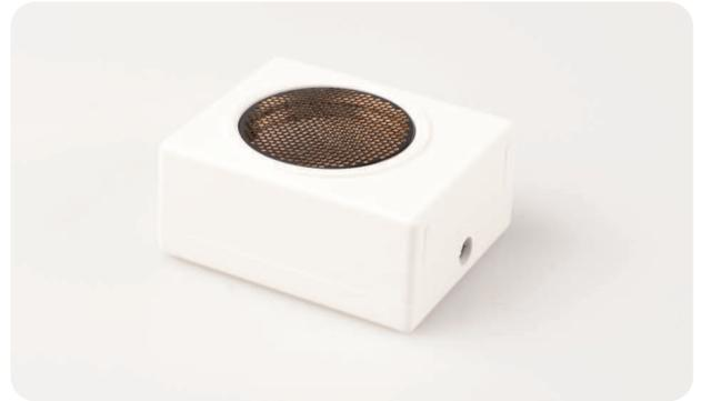
Der Bewegungssensor misst ununterbrochen die Entfernung zwischen dem Detektor und dem (sich bewegendem) Objekt. Während der Sensor läuft, ist ein akustisches Signal (Ticken) hörbar. Der Ultraschall-Bewegungssensor besitzt Befestigungsmöglichkeiten zur stabilen Montage, z.B. mittels eines Statives. Er erfasst die Entfernung von Objekten in einem Bereich von 14 cm bis maximal 6 m, abhängig von der Größe, der Gestalt, der Richtung und der Oberfläche des Objektes.
