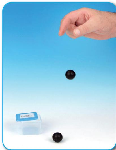
**Versuch:** Wenn beide Bälle auf eine feste Unterlage fallen, so springt nur ein Ball zurück, während der zweite Ball auf der Unterlage liegen bleibt
