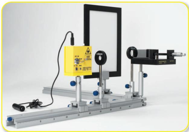
**Versuch:** Messung der Wellenlänge des Laserlichts
