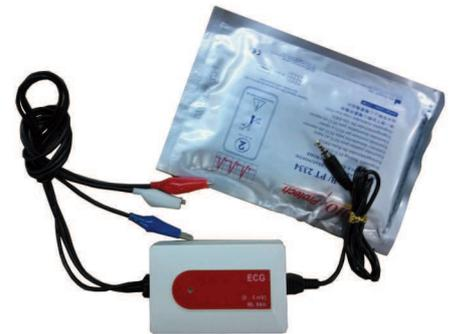
Der EKG-Sensor (Elektrokardiogramm) misst Spannung die vom menschlichen Herzen erzeugt wird.
