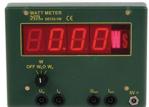
Demonstrations-Messinstrument für Leistungsmessungen in Niederspannungskreisen;
