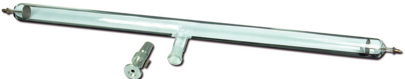
Zur Demonstration der druckabhängigen Leuchterscheinungen bei einer Gasentladung; Dickwandiges Glasrohr mit mittigem Absaugrohr mit NS19/26; an den Enden Scheibenelektroden mit außenliegenden Metallkappen zur Zuführung von Hochspannung; Kupplungsstück aus Metall mit DN 16 Flansch und Belüftungsschraube; Maße: L=700 mm, D=50 mm
