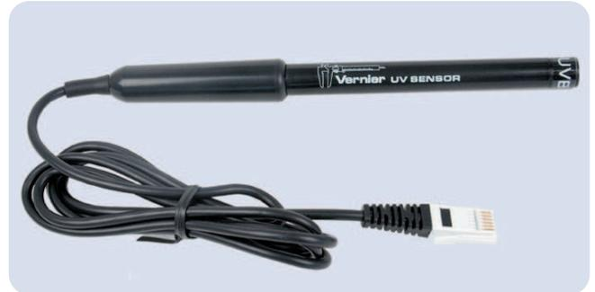
Mit diesem Sensor kann ultraviolettes Licht (ca. 290–320 nm) gemessen werden. Wie UVA-Strahlung, ist auch die UVB-Strahlung mitverantwortlich für die Rötung der Haut und Hautkrebs, beeinflusst aber auch die Vitamin-D-Synthese und sorgen für den Neuaufbau von Pigmenten in der Haut.
