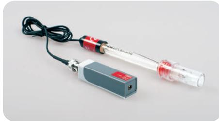
Mit diesem Sensor kann das Reduktionspotential einer Lösung bestimmt werden. Dieses gibt Auskunft über die Fähigkeit einer Lösung als Oxidations- bzw. Reduktionsmittel zu fungieren. Der Sensor besteht aus einer Elektrode und einem Verstärker.
