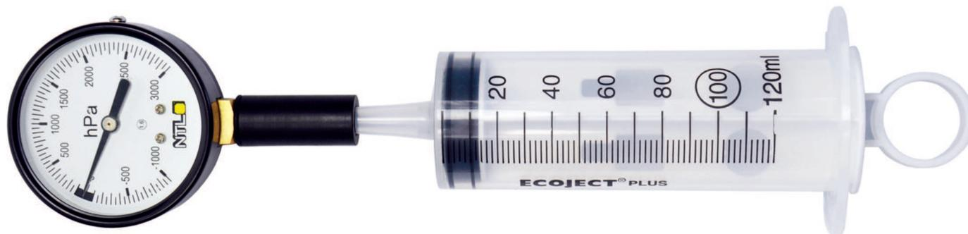
Zur Bestimmung des Zusammenhanges zwischen Druck und Volumen eines Gases bei konstanter Temperatur; Manometer mit zweckmäßiger, übersichtlicher Skala; aufsteckbare Gasspritze mit Skala, aus schlagfestem Kunststoff; gut gedichteter Kolben mit Griffiring; Spritzen-Füllvolumen: 120 ml; Manometer-Bereich: -1000 ... +3000 hPa
