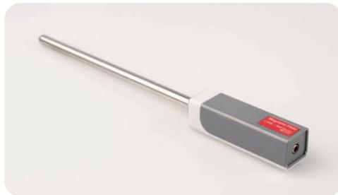
In der Spitze des Sensors befindet sich ein Hall-Element. Das Messergebnis wird am Präzisesten, wenn dieses Element bzw. die Spitze parallel zu dem zu messenden Magnetfeld positioniert wird.
