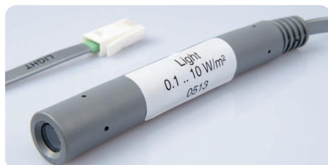
Dieser Lichtsensor misst die Lichtintensität im Bereich von 0,1 bis 10 W/m<sup>2</sup>.
