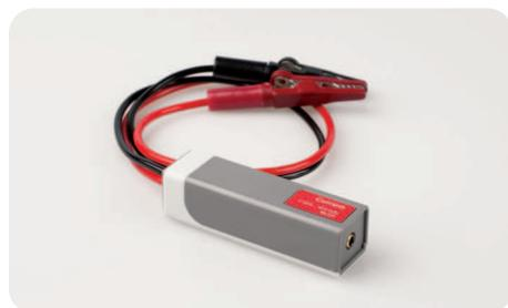
Zur Messung von Strömen in Gleich- und Wechselstromschaltkreisen im Bereich von  $-3$  A bis  $+3$  A.
