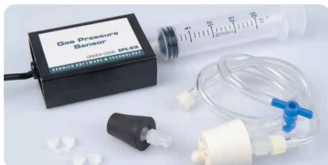
Der Sensor kann dazu verwendet werden um Druckänderungen im Bereich von 0 bis 210 kPa (0 bis 2,1 atm oder 0 bis 1600 mm Hg) zu messen. Der Sensor ist in der Lage Drücke bis 404 kPa (4 atm oder 3040 mm Hg) ohne Beschädigung zu überstehen.
