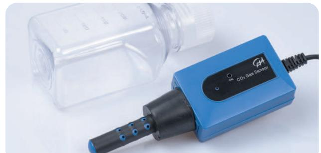
Der CO<sub>2</sub>-Gassensor ist in der Lage CO<sub>2</sub>-Konzentrationen im Bereich von 0 bis 5000ppm zu messen. Bei der Messmethode handelt es sich um die nicht-dispersive Infrarotdetektion (NDIR).
