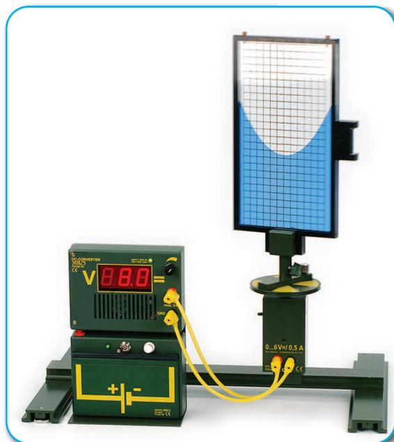
**Versuch:** Rotierende Flüssigkeit – Demo
