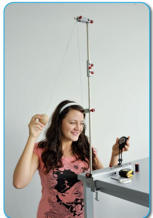
**Versuch:** Schwingungsdauer beim Fadenpendel
