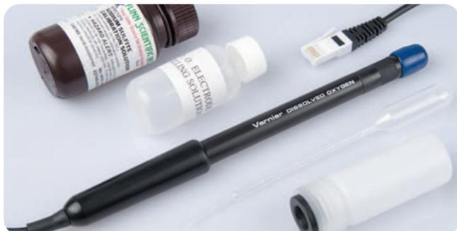
Der Sauerstoffsensor ist in der Lage den Gehalt an gelöstem Sauerstoff in einer wässrigen Lösung zu messen und verfügt über eine automatische Temperaturkompensation.
