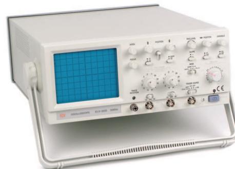
Für Messungen in Demonstrations- und Schülerversuchen; Bildschirmgröße: 80x100 mm, mit Messraster; X-Ablenkung: 0,2 s ... 20 ns/DIV, mit Feinregler; Y-Ablenkung: 1mV ... 5 V/DIV, mit Feinregler; Triggerung: auto, norm, TV-H, TV-V; Betriebsarten: Ch1, Ch2, Ch1+Ch2, Ch1-Ch2, XY-Darstellung; Eingangsimpedanz: 1 MOhm/30 pF, Kopplung: DC, AC, GND; Max. Eingangsspannung: 400 V AC/DC; Anschlussspannung: 230 V AC/50...60 Hz; Abmessungen: ca. 316x132x410 mm, Masse: ca. 7,8 kg
