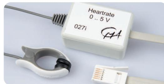
Der Durchblutungssensor ermöglicht es auf eine einfache Art und Weise die Herzfunktion zu untersuchen. Im Gegensatz zu einem EKG, welches das elektrische Signal des Herzens aufzeichnet, liefert dieser Sensor Auskunft über die Flussrate des Blutes in den Adern.
