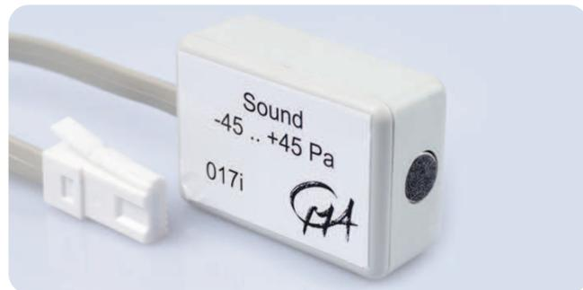
Der Sensor misst die bei einer Schallwelle auftretende Änderung des Luftdrucks. Aufgrund der hohen Sensitivität des Sensors ist dieser sehr gut für die Messung kurzer Druckstöße geeignet, was ebenfalls die Möglichkeit einer Schallgeschwindigkeitsmessung zulässt.
