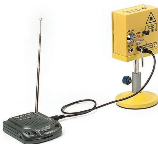
Versuch: Modulationen des Laserlichtes
