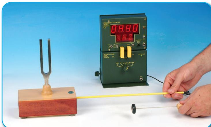
**Versuch:** Messung der Frequenz einer Stimmgabel
