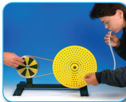
**Versuch:** Lochsirene (Antrieb durch Schwungmaschine Demo DS402-4H)
