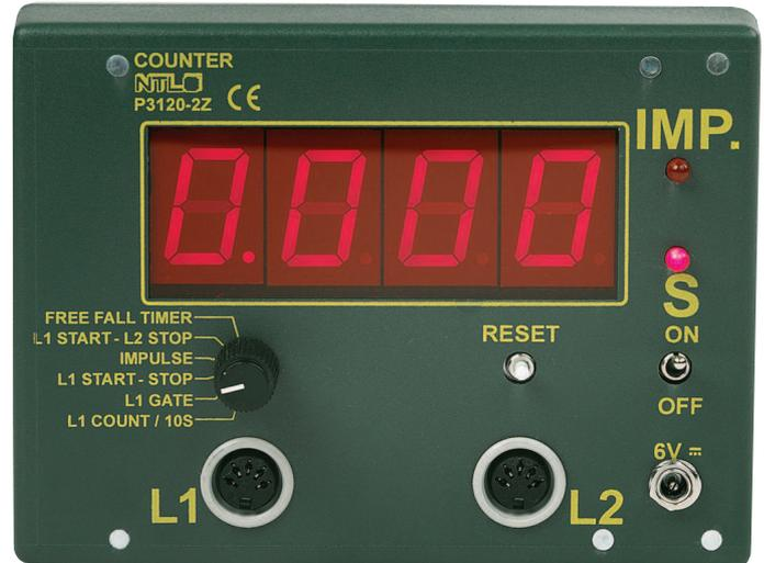
Universell einsetzbarer magnethaftender digitaler Zeitzähler; batteriebetrieben; zum direkten Anschluss der Gabellichtschranken P1320-3LR oder Kugelfallgerät DM340-1F; 26-mm-hohe LED-Anzeige, Auflösung: 1 ms;
