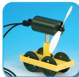
**Versuch:** Durch Motor mit Propeller erzeugter Rückstoß
