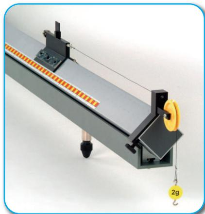
**Detail:** Umlenkrolle und Antriebsmasse (Versuch: Gleichförmig beschleunigte Bewegung)
