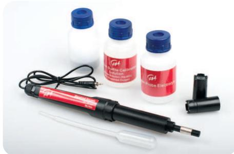
Dieser Sensor misst den Anteil des gelösten Sauerstoffes in Flüssigkeiten. Im Lieferumfang enthalten sind, eine Ersatzmembran, Elektrolyt-Lösung, Natriumsulfit-Kalibrierungslösung, sowie ein Probefläschchen (für Kalibrierung) inklusive Pipette.
