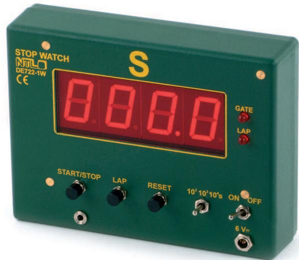
Sehr einfach zu bedienende, magnethaftende Digital-Stoppuhr. Messungen können am Gerät selbst oder mittels des Fernstasters DE722-2W gestartet und gestoppt werden. Die 26-mm-hohe LED-Anzeige gewährt weithin sichtbare Ablesemöglichkeit. Funktionen: START/STOP: startet oder stoppt die Messung, LAP: speichert die Zwischenzeit
