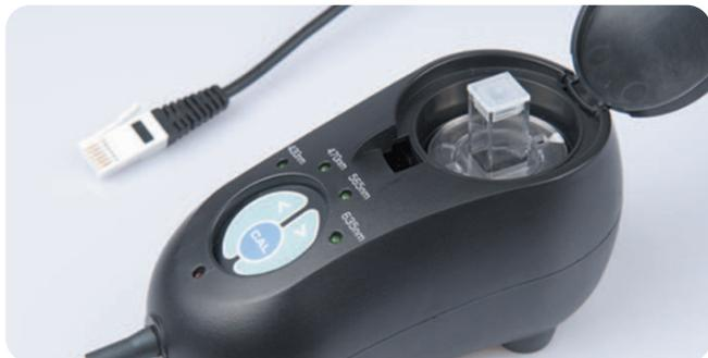
Das Fotometer ist in der Lage die Konzentration einer Lösung aufgrund deren Farbintensität zu ermitteln. Dabei wird die Transmission, also jenes Licht das durch die Lösung durchtritt, gemessen. Für die Messung kann zwischen vier Wellenlängenbereichen gewählt werden.
