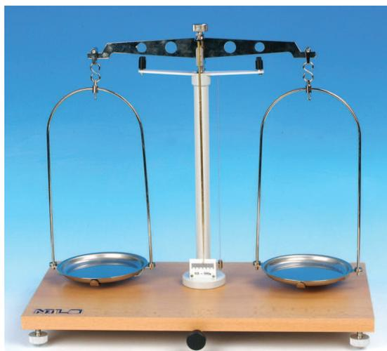
Präzisionswaage mit gehärteter Stahlschneide; 2 abnehmbare Metallschalen, D=125 mm; Drehknopf zur Arretierung; Grundplatte mit Justierschrauben; Lot zur exakten waagrecht Positionierung; Wägebereich: 500 g; Empfindlichkeit: 0,005 g; Abmessungen: 460x250x410 mm
