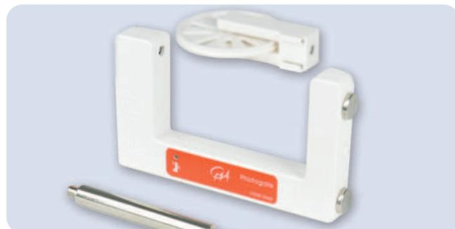
Die Gabellichtschranke wird mit einem aufsteckbaren Speicherrad mit Schnurrille und einer Stativstange geliefert. Sie kann entweder direkt über ein Interface verbunden, oder mit zusätzlichen Kabeln, an bis zu 5 weiteren Gabellichtschranken gekoppelt werden.
