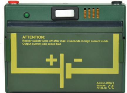
**Ein thermischer Sicherheitsschalter unterbricht den Ausgang bei Hochstromversuchen (Kurzschlussstrom > 30 A) und schützt dadurch den Akku!**
