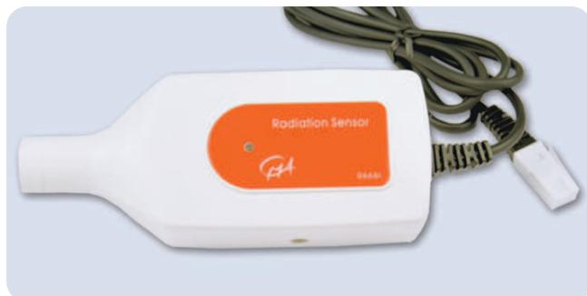
Geiger-Müller-Zähler mit Zählrohr für  $\alpha$ -,  $\beta$ - und  $\gamma$ -Strahlung. Er ist geeignet um schwache Strahlungen zu messen. Akustische und optische Anzeige direkt durch den Sensor. Bereich: 0–1000 cps (Zählungen pro Sekunde) Gamma-Empfindlichkeit: 18 cps
