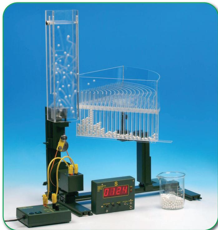
**Versuch:** Maxwell'sche Geschwindigkeitsverteilung eines Modellgases
