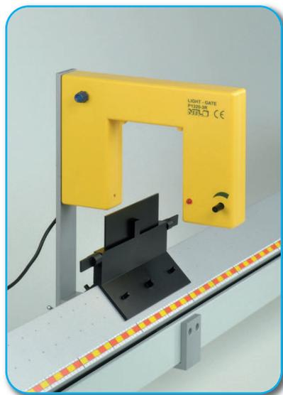
**Detail:** Befestigung des Halters für Gabellichtschranken an der Luftkissenfahrbahn
