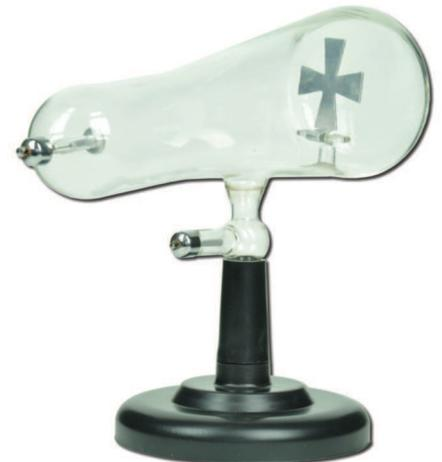
Zum Nachweis der geradlinigen Ausbreitung von Elektronenstrahlen; Vakuum-Glasrohr mit Elektroden und außenliegenden Metallkappen; Metallkreuz; mit Kunststofffuß; Betriebsspannung: ca. 2-3 kV, Glasrohr: L=ca. 230 mm, D=ca. 80 mm
