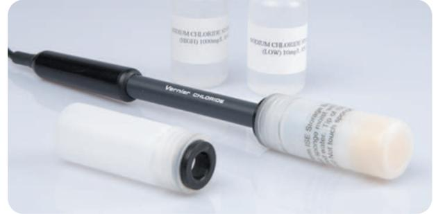
Der Chloridsensor ist in der Lage die Konzentration an Cl<sup>-</sup>-Ionen in wässriger Lösung zu messen und den Messwert in mg/L, ppm oder mol/L auszugeben.
