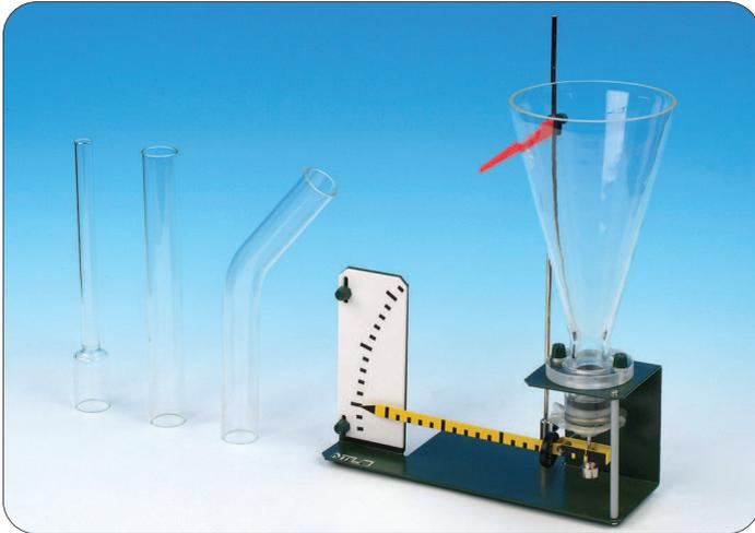
Zur Demonstration des Hydrostatischen Paradoxons; der Bodendruck der Wassersäule wird durch Verformung einer Membrane auf einen 200 mm langen Hebel übertragen, und auf einer großen Skala angezeigt; 4 verschieden geformte Gefäßaufsätze aus Glas, Höhe: jeweils ca. 220 mm, D(unten/innen)=23 mm; höhenverstellbarer Zeiger zur Markierung der Füllhöhe; Abmessungen: 260x100x360 mm
