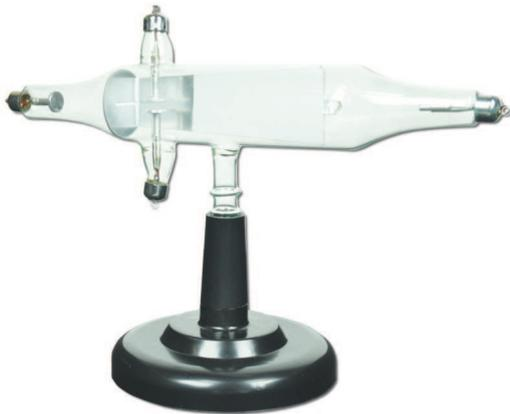
Zur Demonstration der Ablenkung von Elektronenstrahlen im magnetischen Feld; Vakuum-Glasrohr mit Elektroden und außenliegenden Metallkappen; Spaltblende und Leuchtschirm (ca. 75 x 35 mm); zwei horizontal angeordnete Elektroden zur Ablenkung des Elektronenstrahls; mit Kunststofffuß; Betriebsspannung: ca. 2-3 kV Glasrohr: L=ca. 270 mm, D=ca. 40 mm
