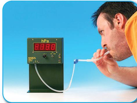
**Versuch:** Messung des Unterdruckes am Zerstäuber
