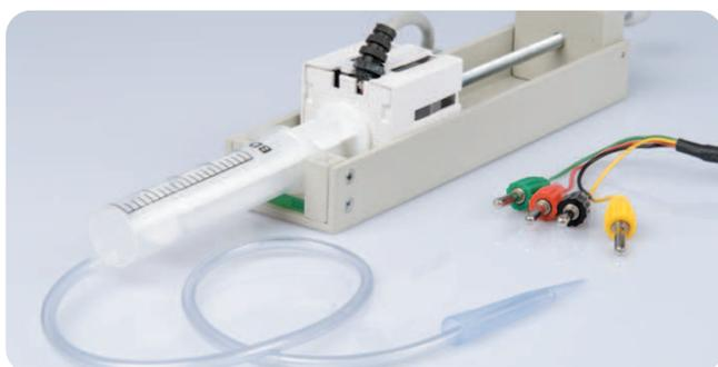
Die motorbetriebene Bürette, auch Titrator genannt, ist eine günstige und präzise Dosierhilfe für Titranten in Titrationsexperimenten.
