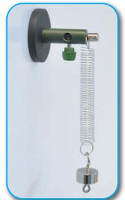
**DS110-43** Magnetfuß 43, mit Säule und Lagerbolzen
