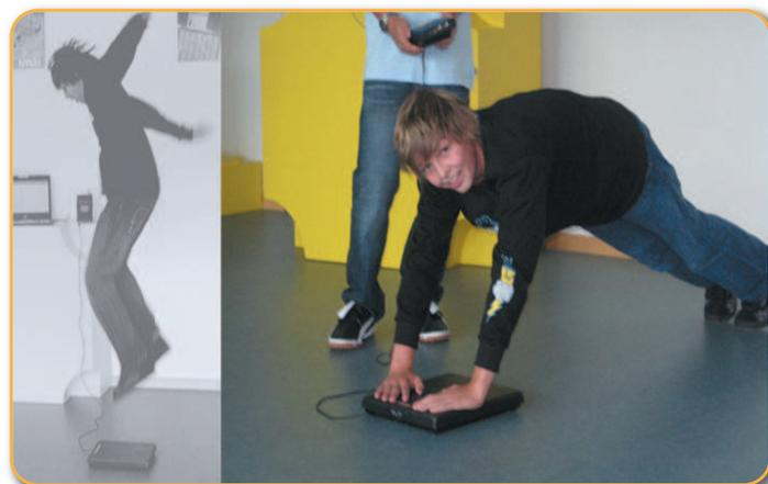
Die Druckplatte wurde entwickelt um Experimente mit hohem Kraftaufkommen durchzuführen. Es kann beispielsweise die Kraft beim Treten, Springen und anderen Bewegungen gemessen werden.
