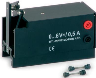
Ein Gleichstrommotor mit angeflanschtem Exzenter steuert die Geschwindigkeit der Pendelbewegung der Erregerplatte. Durch Änderung der Gleichspannung wird die Pendelfrequenz der Erregerplatte erhöht bzw. verringert. Gehäuse aus Aluminium, L=14 cm, auf Alu-Spezialprofil, mit zwei 4-mm-Sicherheitsbuchsen, koppelbar an ein Ende des Schwingungsmoduls 1; Lieferung mit zwei Kopplungsspiralen
