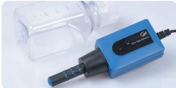
Der CO<sub>2</sub>-Gassensor ist in der Lage Kohlendioxidkonzentrationen im Bereich von 0 bis 5000ppm zu messen. Bei der Messmethode handelt es sich um die nicht-dispersive Infrarotdetektion (NDIR).
