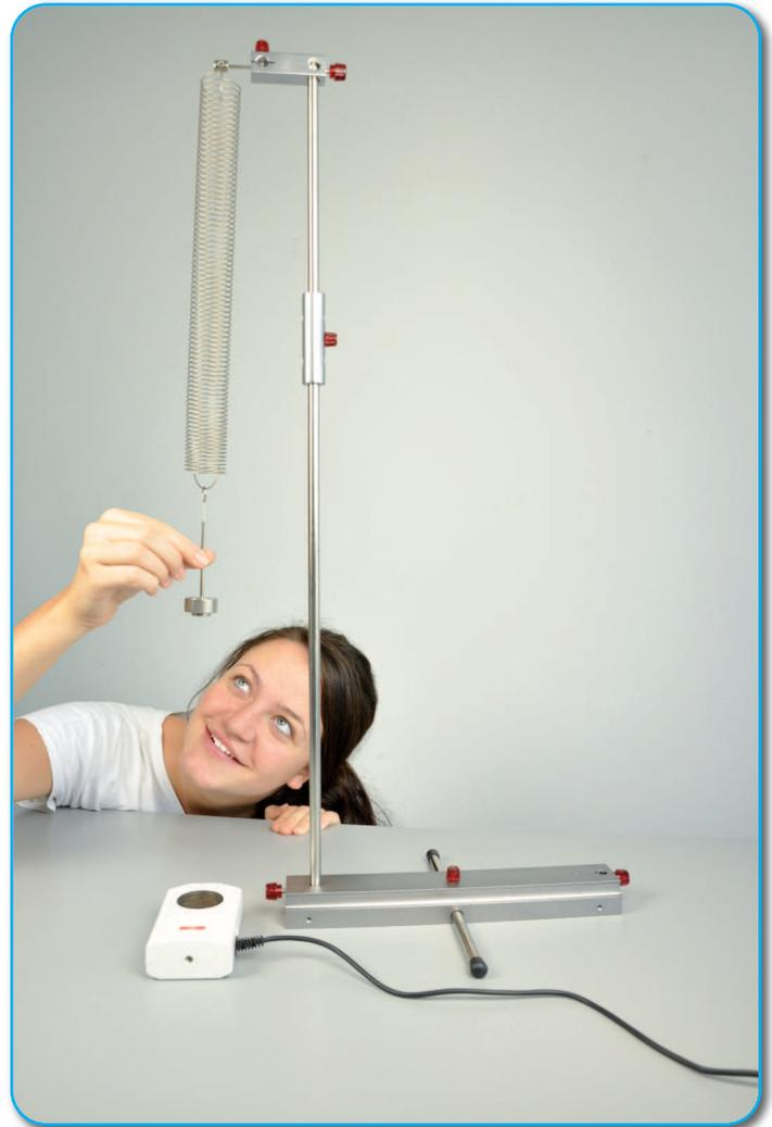
Versuch: Schwingungsdauer beim Federpendel
