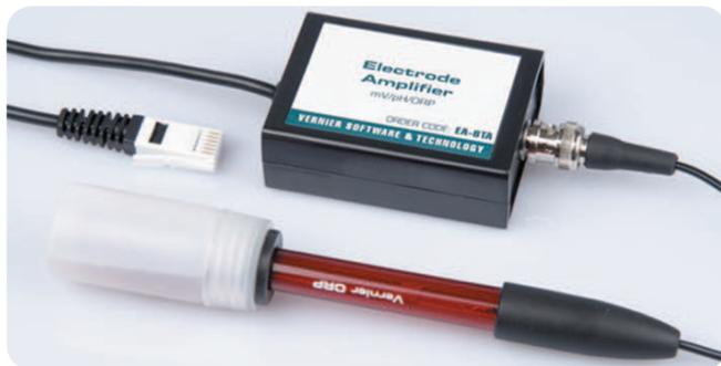
Um das Reduktionspotential einer Lösung zu messen. Dieses gibt Auskunft über die Fähigkeit einer Lösung als Oxidations- bzw. Reduktionsmittel zu fungieren.
