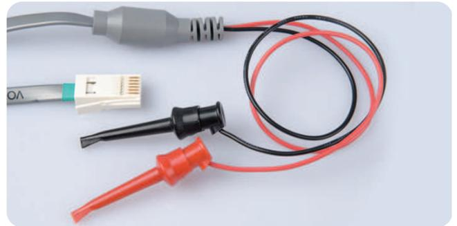
Ein vielseitig einsetzbarer Sensor, der Spannungswerte im Bereich von  $\pm 10$  V messen kann.
