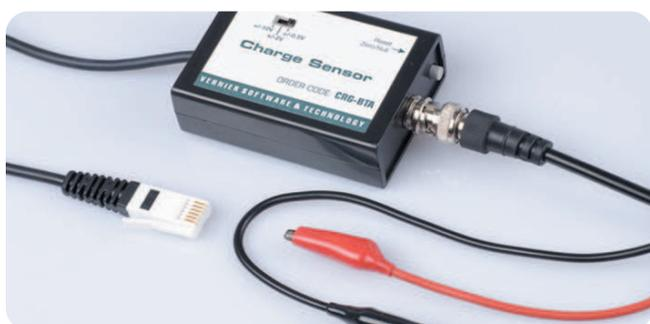
Der Ladungssensor misst und bestimmt elektrostatische Ladungen, sowie Ladungspolaritäten und kann als Ersatz für ein Elektroskop verwendet werden. 3 Messbereiche:  $\pm 5/\pm 20/\pm 97$  nC Auflösung: 0,020/0,010/0,047 nC
