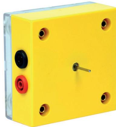
Leicht anlaufender Motor (Solarmotor) mit langer Welle zur Kopplung mit der Peltonturbine oder Propeller; oben 4 Ausnehmungen zur Arretierung der Peltonturbine; seitlich zwei 4-mm-Sicherheitsbuchsen; Anlauf bereits bei etwa 200 mV/ 20...30 mA!; magnethaftendes Gehäuse mit transparenter Bodenplatte; Abmessungen: 84x84x39 mm
