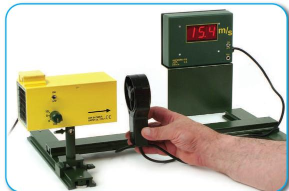
Versuch: Messung der Strömungsgeschwindigkeit
