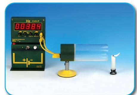
Versuch: Ausbreitung von Schallwellen in Luft
