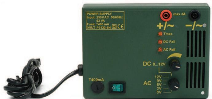
Stufenlos stellbare und stabilisierte Gleichspannung sowie fest einstellbare Wechselfspannung; elektronischer Überlastschutz; zur **magnethaftenden** Halterung sind in der Rückwand 10 starke Neodymiummagnete eingesetzt;
