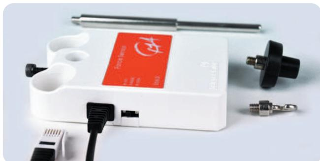
Ein vielseitig anwendbares Gerät um Kräfte zu messen. Er kann sowohl an einer Stativstange als auch auf beweglichen Körpern befestigt werden, um Zug- oder Stoßkräfte zu messen. Messbereich:  $\pm 5$  N/ $\pm 50$  N Maximale Belastung:  $\pm 80$  N
