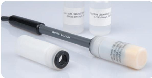
Der Calciumsensor ist in der Lage die Konzentration an Ca<sub>2+</sub>-Ionen in wässriger Lösung zu messen, und den Messwert in mg/L, ppm oder mol/L auszugeben.
