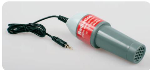
Dieser Sensor ist geeignet um schwache  $\alpha$ -,  $\beta$ - und  $\gamma$ -Strahlung zu messen. Der Messbereich liegt bei 0 bis 20.000 Zählungen pro Minute (cpm).
