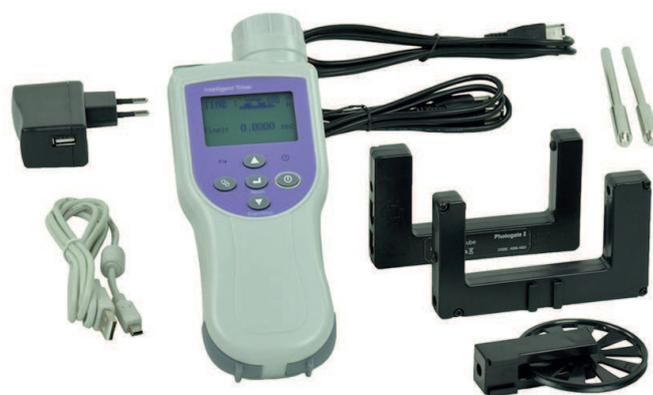
Kompakte, intelligente Zeitmesseinheit; durch die exakte 0,1 ms-Auflösung und eine einfach bedienbare Menüführung mit Speichermöglichkeiten sind Experimente zur Bewegungslehre einfach mess- und berechenbar; mit Gabellichtschranken und -Speichenrad können auch Resultate für Geschwindigkeit und Beschleunigung angezeigt werden;
