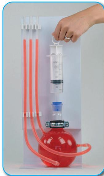
**Versuch:** Druckverteilung in Flüssigkeiten
